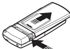
2. Снимите аккумулятор, подняв его из гнезда.
