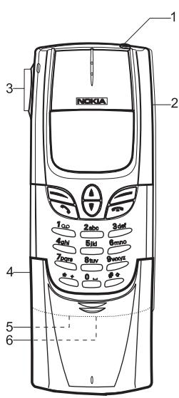
**1. Клавиша включения.** Для включения или выключения телефона нажмите и удерживайте нажатой клавишу ① в верхней части телефона.
