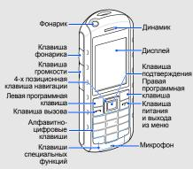
На задней панели телефона находятся следующие клавиши и функции:
