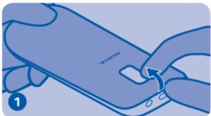
Выключите телефон, затем снимите заднюю крышку.
