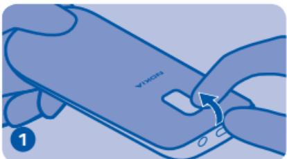
Выключите телефон, затем снимите заднюю крышку.
