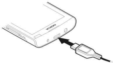
Для начала зарядки по USB требуется более длительное время, и зарядка может не выполняться при подключении к концентратору USB, на который не подается питание. При подключении к сетевой розетке устройство заряжается быстрее.
