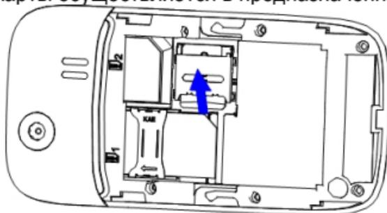
Извлечение аккумулятора, SIM карт и micro-SD карты производится в обратном порядке.
