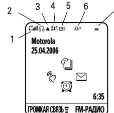
**1 Индикатор интенсивности сигнала** – отображает интенсивность сигнала сетевого соединения.
