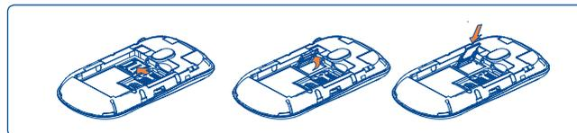
Для открытия фиксатора карты microSD сдвиньте его в направлении, указанном стрелкой, и поднимите его. Затем установите карту microSD позолоченными контактами вниз. Опустите фиксатор карты microSD и защелкните его, сдвинув в направлении, противоположном указанному стрелкой.
