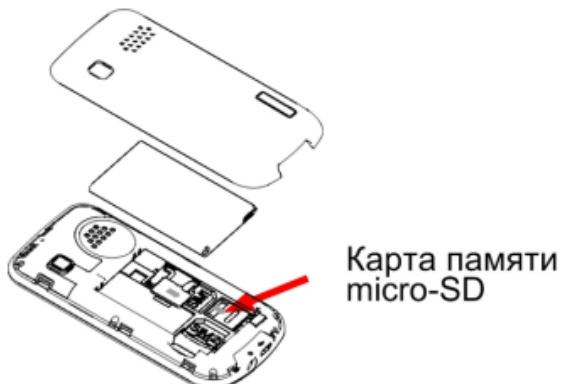
Извлечение аккумулятора, SIM карт и micro-SD карты производится в обратном порядке.
