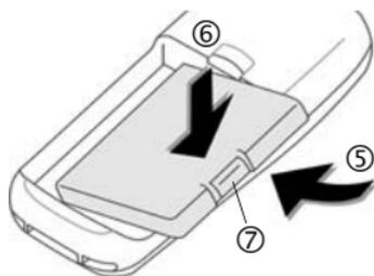
Для извлечения аккумулятора нажмите защелку ⑦, затем выньте его.
