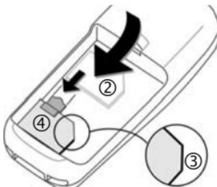
Вставьте аккумулятор в телефон боковой стороной ⑤, затем нажмите на него ⑥. Аккумулятор должен зафиксироваться.
