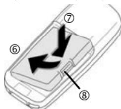
Для извлечения аккумулятора нажмите на защелку ⑧, затем выньте аккумулятор.
